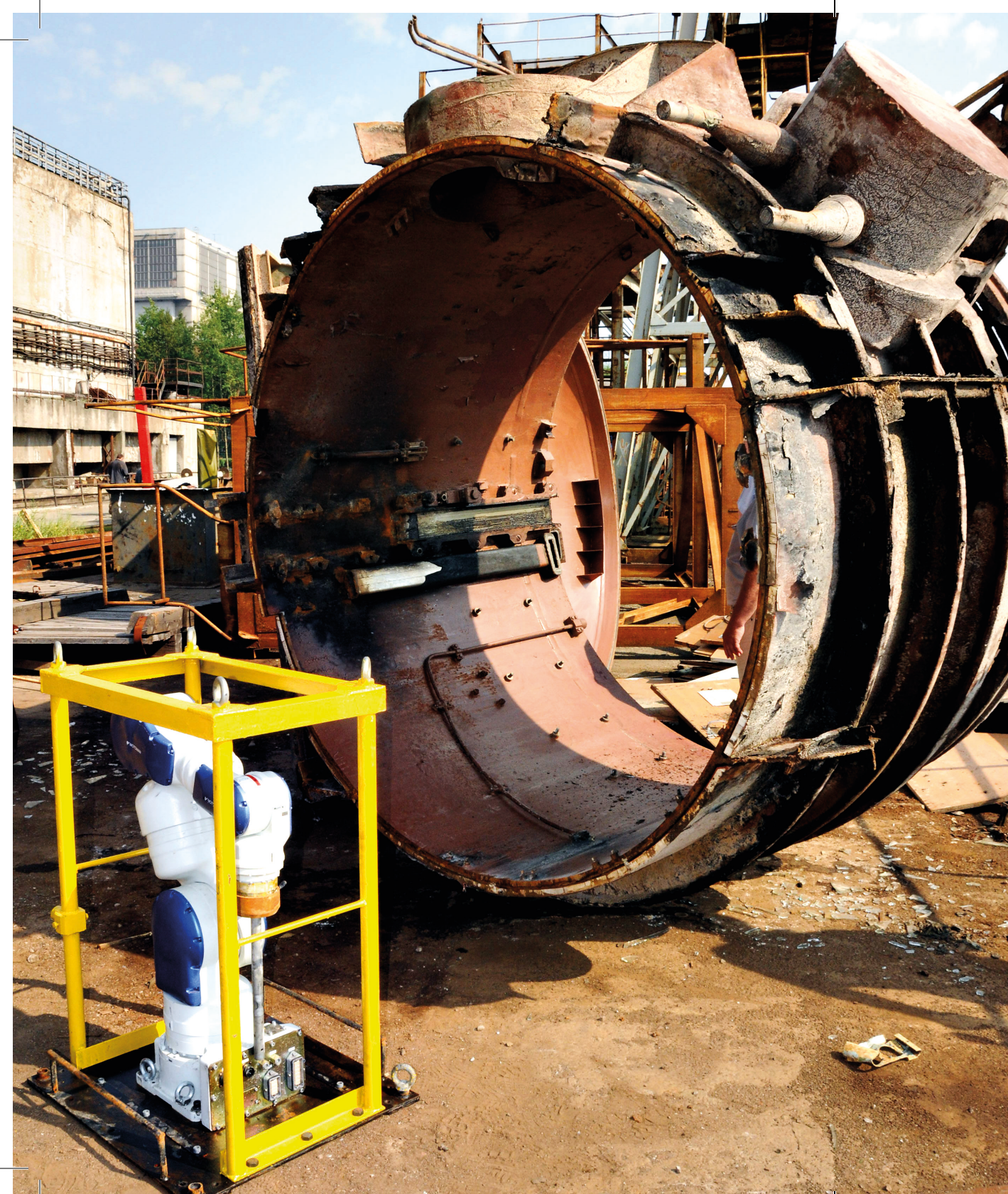
фрагмент ракетной шахты АПЛ, вырезанный гидрорезным оборудованием РФЯЦ-ВНИИТФ
